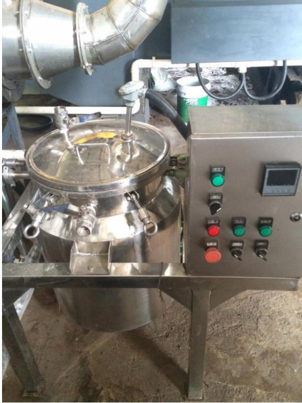
Gambar 8: Tangki pembiakan mikrob (kiri), dan unit penulenan udara (kanan)
