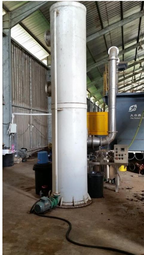
Gambar 8: Tangki pembiakan mikrob (kiri), dan unit penulenan udara (kanan)
