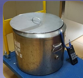
Peralatan pembekuan semen secara manual: Tong besi, thermocouple, cecair liquid
